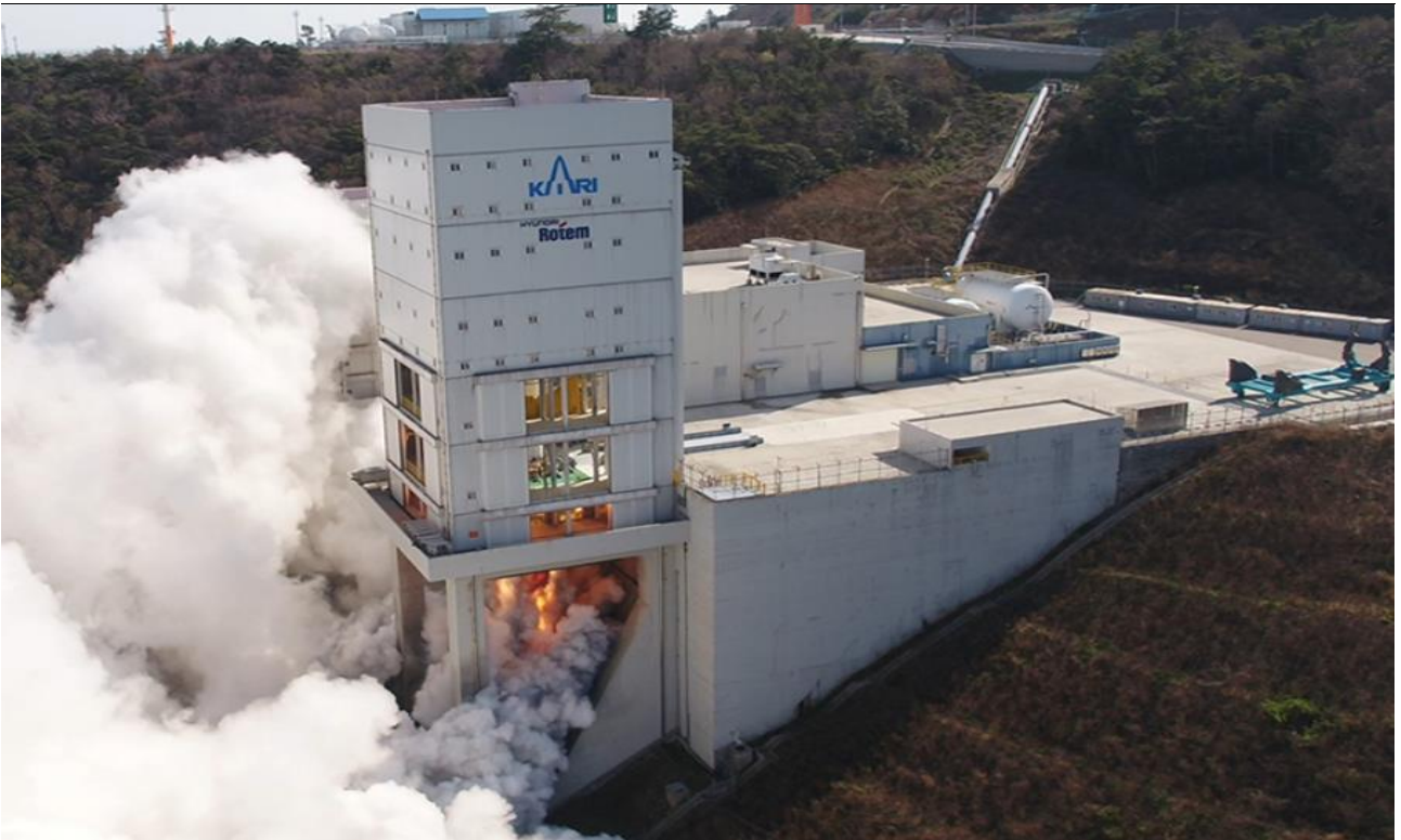
그림13. 현대로템이 구축한 한국형발사체 추진기관시스템 시험설비
